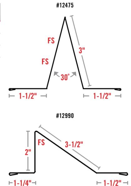
► ENDWALL AND SIDEWALL FLASHING AND GAMBREL ROOF JOINT
